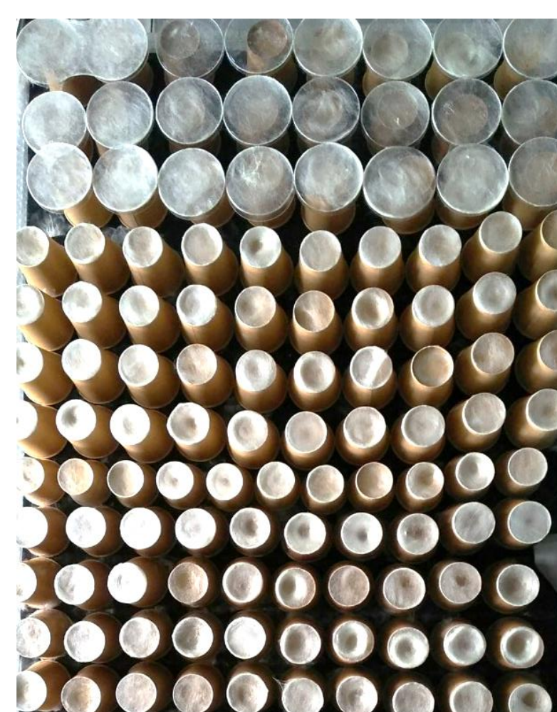
図16. 平面吐糸の特徴を活かして生成された多数の円の不織布
